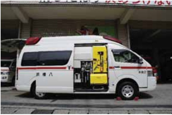
右側スライドドア内にレスキュー資機材4点セットを装備
