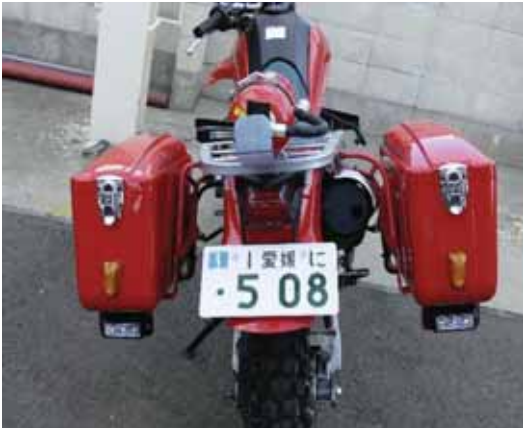
車両後部両サイドに収納ボックス、LED赤色灯を装備している。
