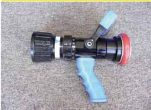
ガンタイプの放水ノズルで放水の量を調整することができます。
