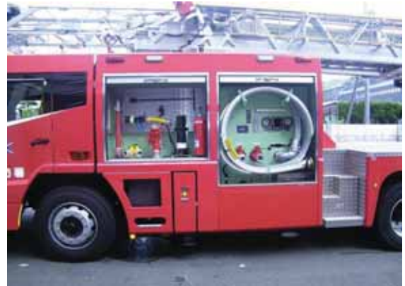
放水ポンプ機能も装備しています。
