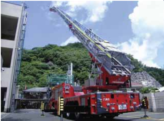
梯子を起伏・伸梯させた状況
