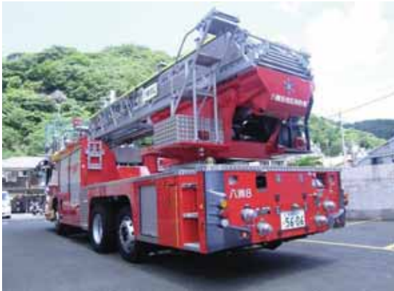
はしごはストロング梯体を採用しています。伸梯は全段が同時に伸梯します。
